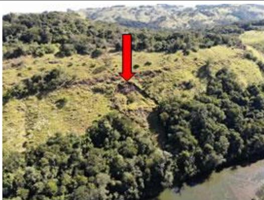
Foto 5-25. Vista aérea de antigo deslizamento de talude na ME do reservatório, confrontante ao Rio Azul.
