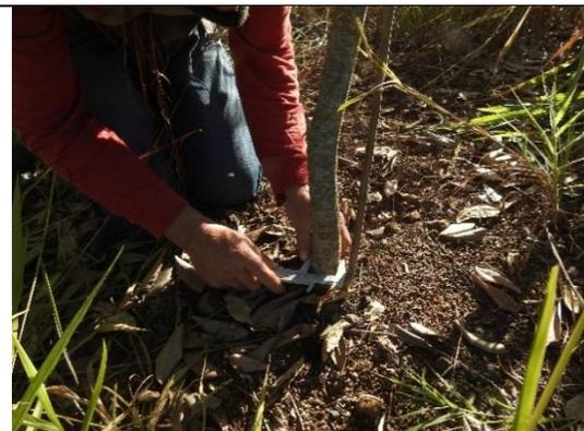
Foto 6-4. Medição do diâmetro da base de tronco com uso de paquímetro analógico.
