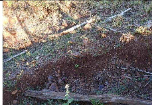
Foto 5-30. Vista parcial da erosão do tipo sulco evidenciando as dimensões desse processo.
