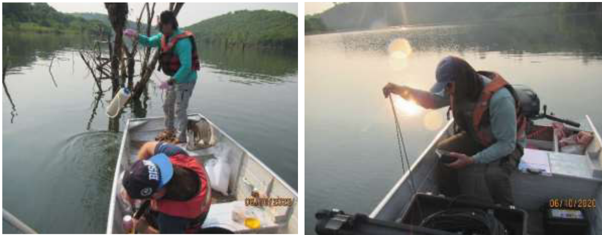
Figura 5.3.2.1 – Coleta de água nas camadas do Reservatório e aferição dos parâmetros em campo.
