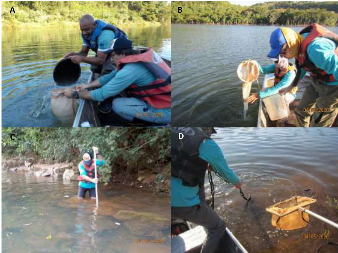
Figura 5.3.2.2 – Coleta de Fitoplâncton e Zooplâncton com rede de 20 e 68 \mu\text{m} , respectivamente (A; B); macroinvertebrados bentônicos com “kick sampling” (C) e draga de Petersen (D) na área de influência da PCH Cantu 2, rio Cantu.
