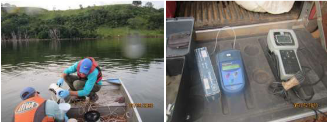
Figura 5.3.2.1 – Coleta de água nas camadas do Reservatório e aferição dos parâmetros em campo.
