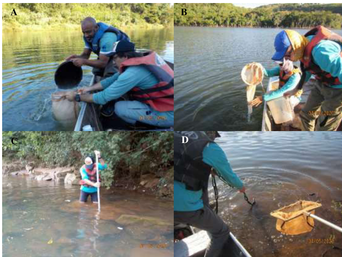
Figura 11 – Coleta de Fitoplâncton e Zooplâncton com rede de 20 e 68 \mu m respectivamente (A; B); e macroinvertebrados bentônicos com “kick sampling” (C) e draga de Petersen (D) na área de influência da PCH Cantu 2, rio Cantu.
