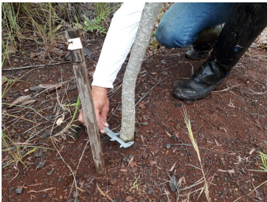
Figura 2.3.4.4: Medição do diâmetro com o auxílio de paquímetro.
