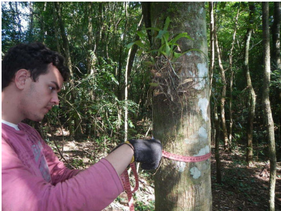
Figura 7.4.2: Medição de CAP com fita métrica.
