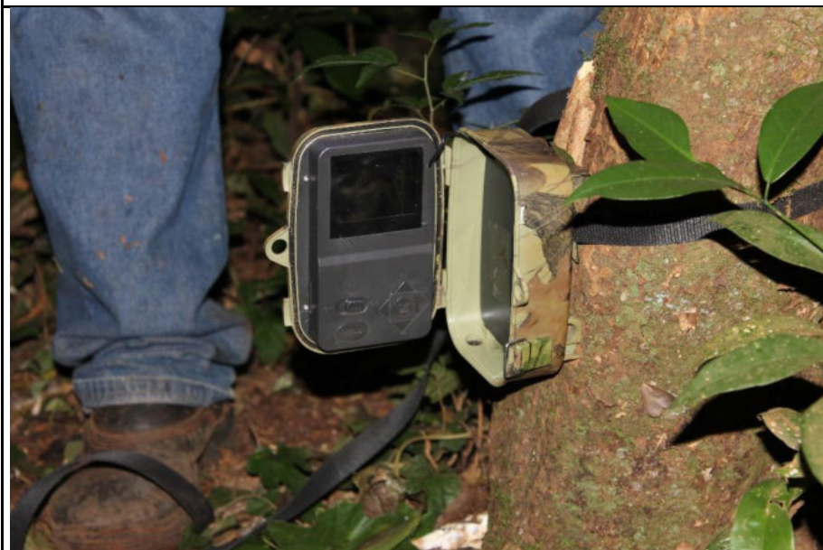
Montagem de armadilha do tipo câmera trap.
