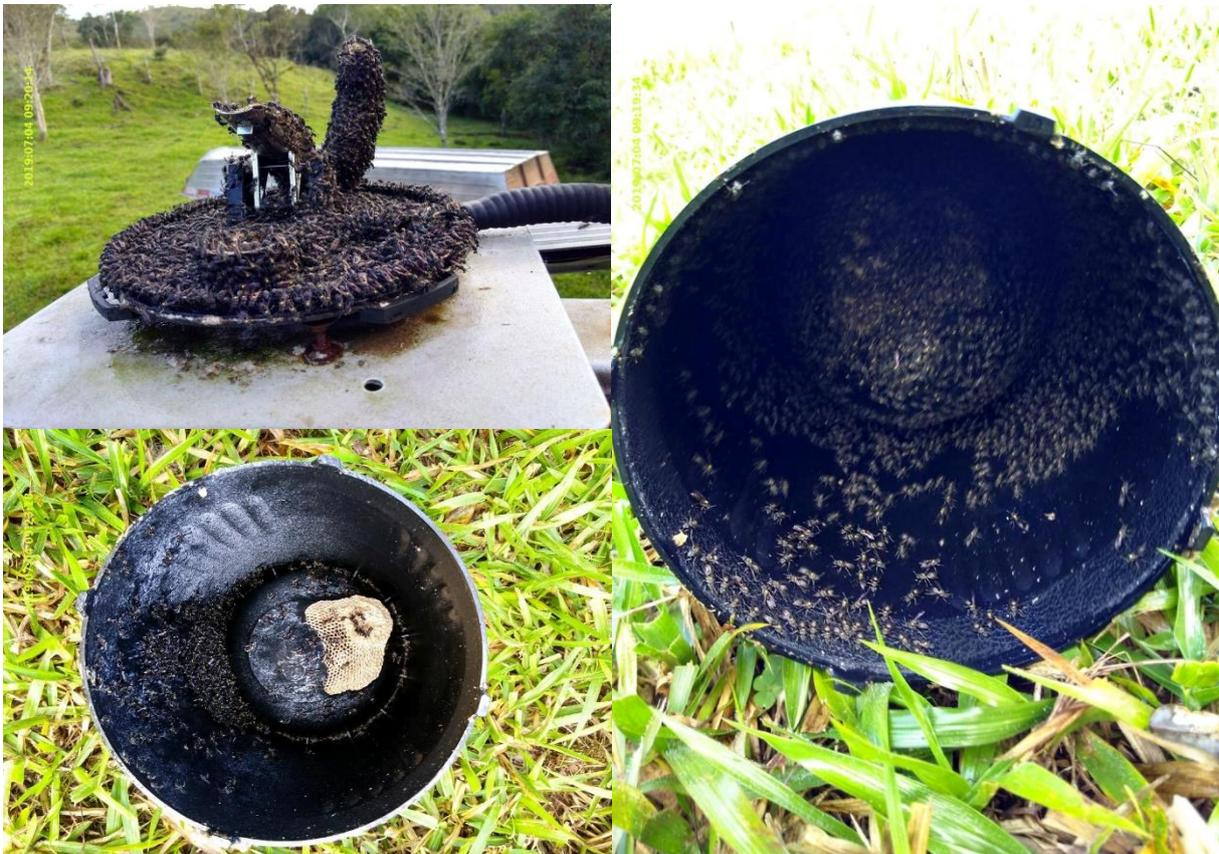
**Observação:** Foi realizada a remoção de uma colmeia que estava obstruindo o pluviômetro (sensor de precipitação). Após a retirada dos insetos foi feito teste pluviométrico com 11 basculadas às 9h30min marcadas corretamente no sistema.
