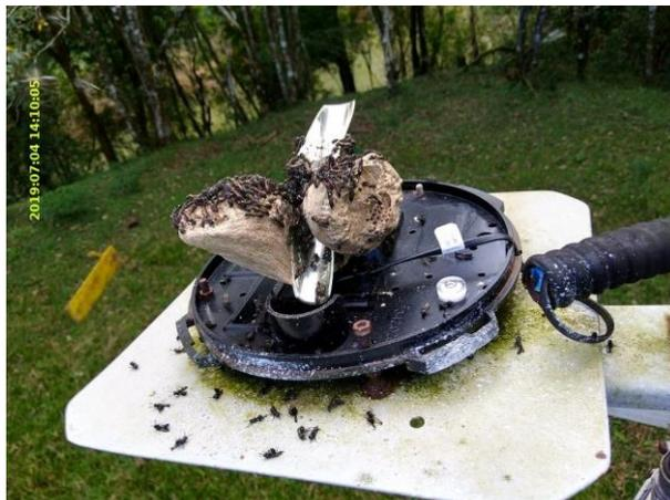
**Observação:** Foi realizada a remoção de uma colmeia que estava obstruindo o pluviômetro (sensor de precipitação). Após a retirada dos insetos foi feito teste pluviométrico com 34 basculadas entre às 14 horas e 14h30min marcadas corretamente no sistema.
