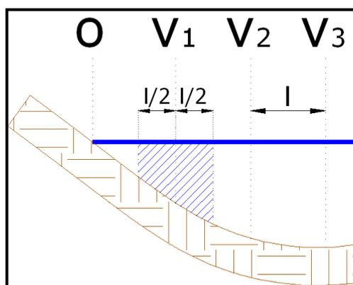
Figura 3 – Delimitação da subseção da vertical 1
