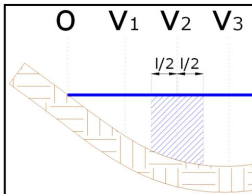
Figura 4 – Delimitação da subseção da vertical 2
