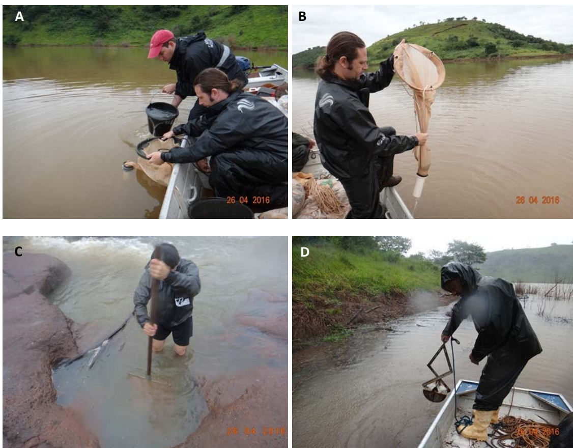
Figuras 4.6.6.1.1 A/ 4.6.6.1.1 B/ 4.6.6.1.1 C e 4.6.6.1.1 D – Coleta de Fito e Zooplâncton com rede de 20 e 68 \mu m respectivamente (A; B); e macroinvertebrados bentônicos com “kick sampling” (C) e draga de Petersen (D) na área de influência da PCH Cantu 2, rio Cantu.
