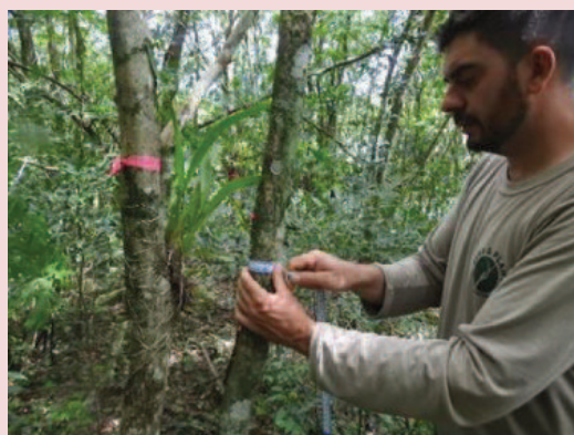
Foto 5-28. Vista da medição da circunferência à altura no peito das árvores com o uso de fita métrica na parcela 2ME.
