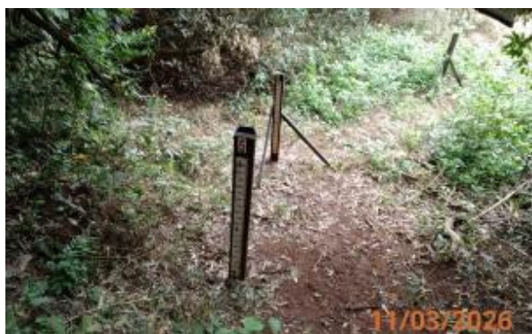
Vista geral da seção de réguas
