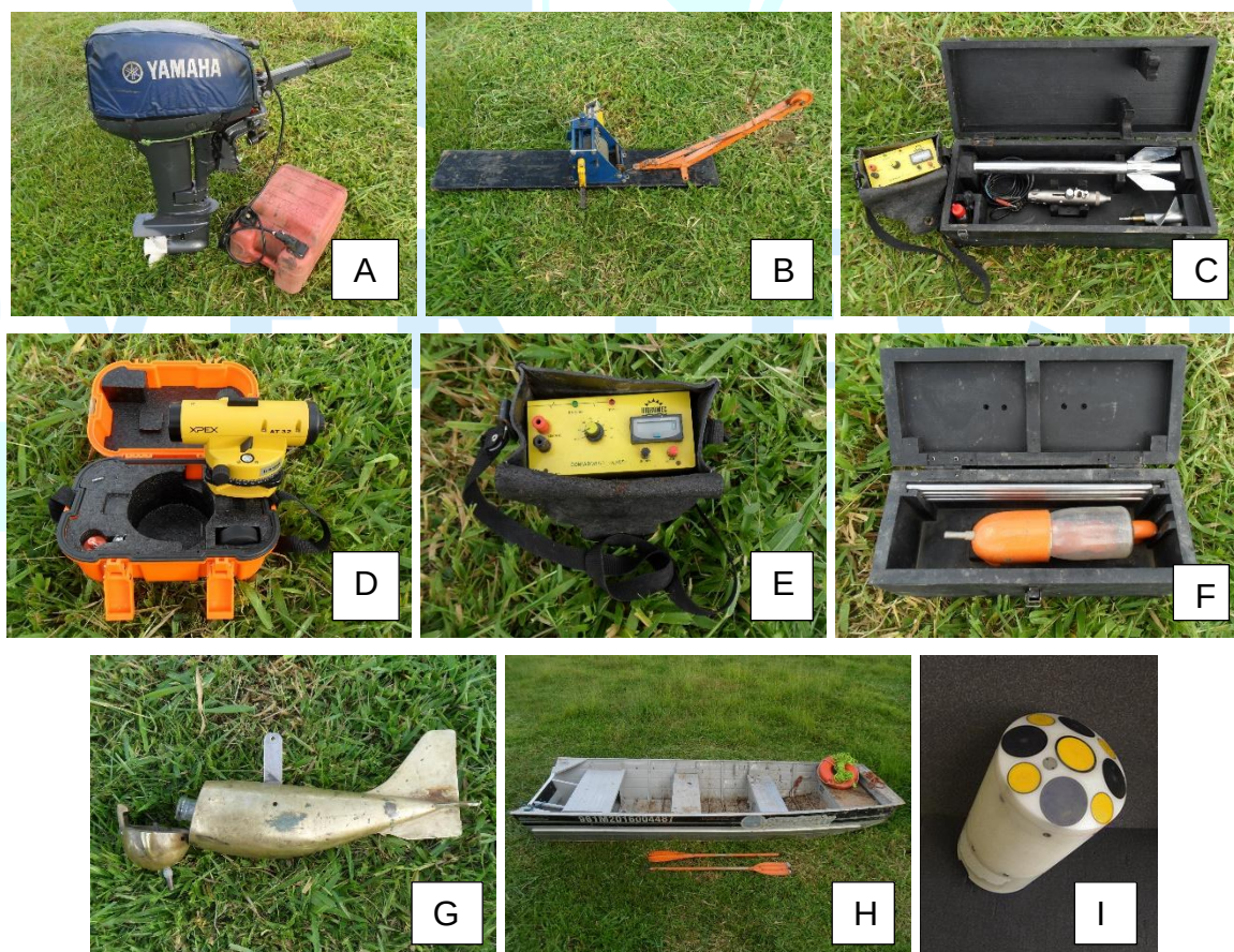
Figura 2. Equipamentos empregados no monitoramento hidrométrico.
