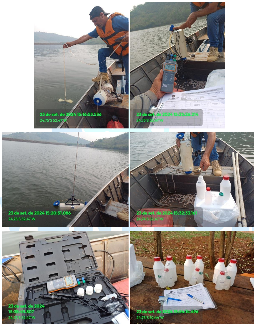
Figura 8 - Monitoramento de Qualidade de Água na PCH Cantu 2 Barramento.
