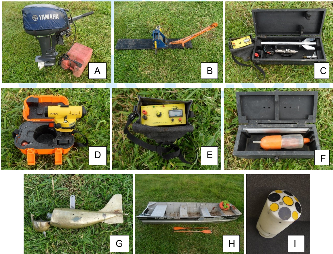
Figura 2. Equipamentos empregados no monitoramento hidrométrico.
