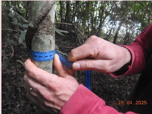
Foto 5-1. Medida da Circunferência à Altura do Peito – CAP com o uso de fita métrica.
