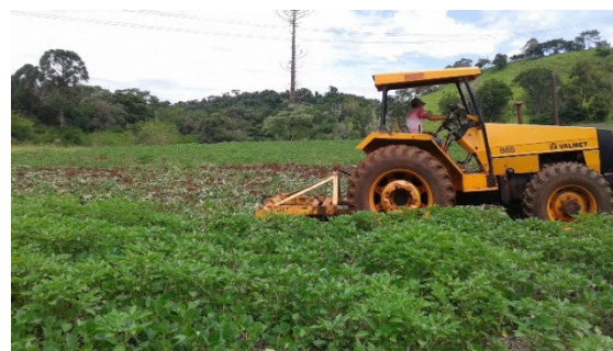
Figura 38 (A e B): Detalhe do “soqueiro” de soja (A) e o Trator + Sub-Solador trabalhando na área (B).
