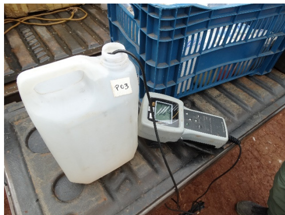
Figura 3.3.8 – Monitoramento da qualidade da água com OXÍMETRO.
