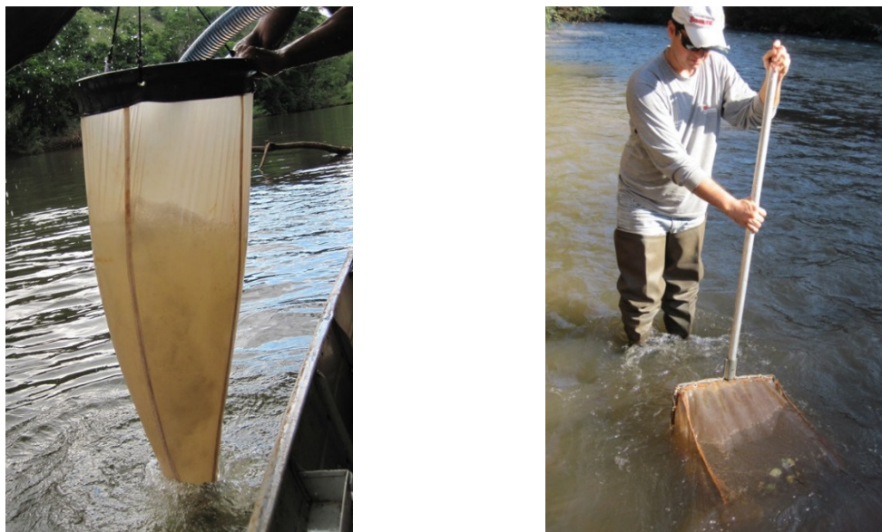
Figura 3.4.2 – Coleta de Fito e Zooplâncton com rede de 20 e 68 µm respectivamente (A); e macroinvertebrados bentônicos com "kick sampling" (B) na área de influência da futura PCH Cantu 2, rio Cantu
