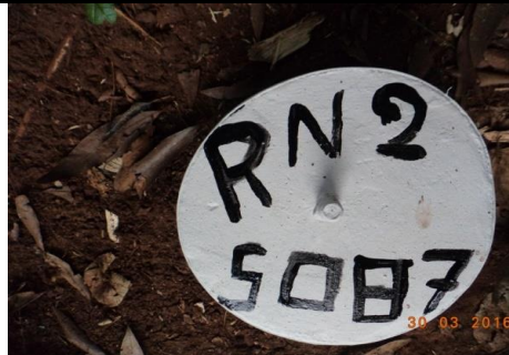
RN - 2 RN instalado
